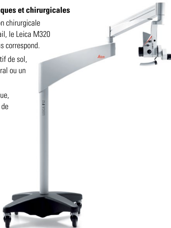
Le revêtement Leica AgProtect antimicrobien en nanoparticules d'argent (Ag) réduit le nombre d'agents pathogènes à la surface du microscope
